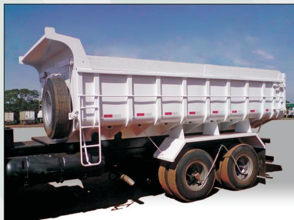
São montados diretamente no caminhão sobre o chassi ou através de chassi independente em sobreposição.
